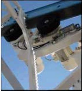
Energieeffizienter, elektrischer Antrieb über Reibradpaare
